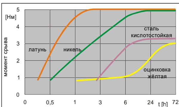
На графике представлен рост момента срыва резьбового соединения в зависимости от времени при использовании активатора А. Испытания были выполнены согласно норме ISO 10964 с использованием винтов и гаек М10 среднего качества.
